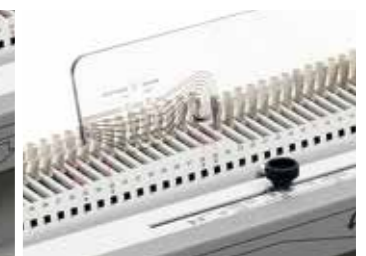
System wyłączanych noży, niezbędny do wykonania kalendarzy.
