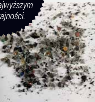
Zdjęcie przedstawia w powiększeniu efekt niszczenia magnetycznego dysku twardego.
